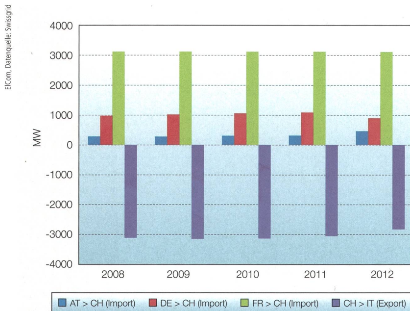
Bild 2 Während der durchschnittliche NTC am Schweizer Norddach konstant bei zirka 4500 MW liegt, hat die Exportkapazität in Richtung Italien 2012 deutlich abgenommen.
