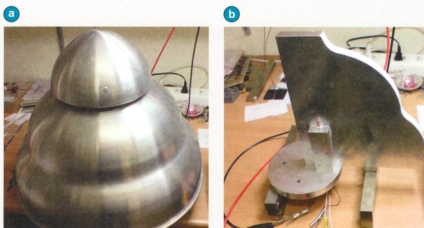
Bild 5 a) Originalhaube und b) einer der 4 Entwärmungsflügel.
