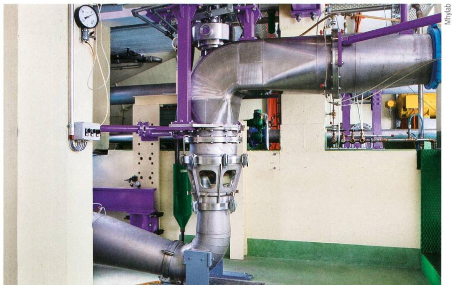
**Figure 3** Turbine Diagonale sur stand d'essais.
