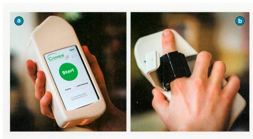
Bild 3 Prototyp des neuen Comes All-in-One-Endgerätes, a) Vorderansicht mit Bedienfeld über Touchscreen, b) Rückansicht mit Sensor-Manchette.
