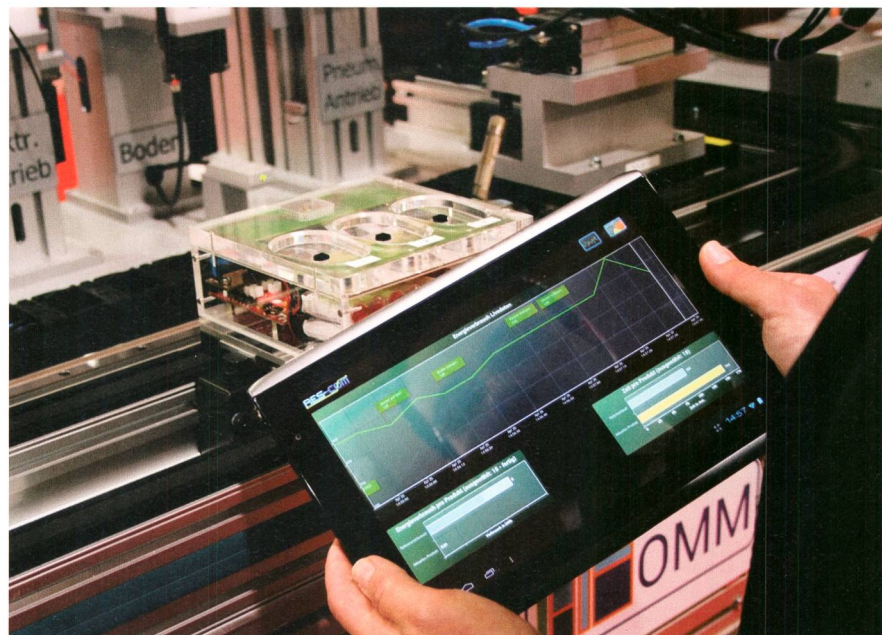
Anzeige des aktuellen Energieverbrauchs auf Tablet.
