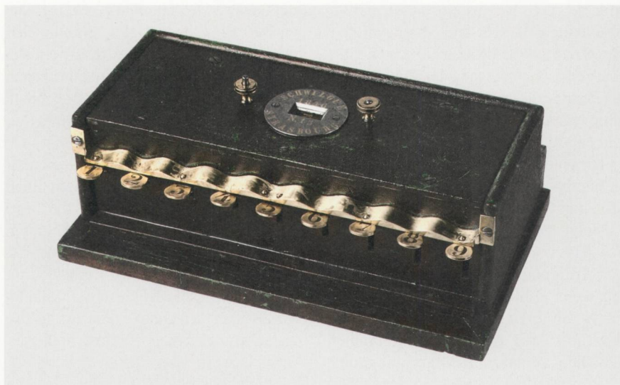
Bild 3 Schwilgué-Tastenaddiermaschine des Historischen Museums in Strassburg.
