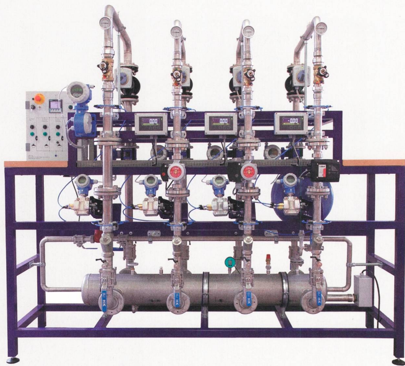
Figure 2 Banc d'essais avec, de droite à gauche, le moteur synchrone, le moteur asynchrone avec convertisseur de fréquence, le moteur asynchrone à commutation de bobinage et finalement l'emplacement prévu pour tester une quatrième pompe.
