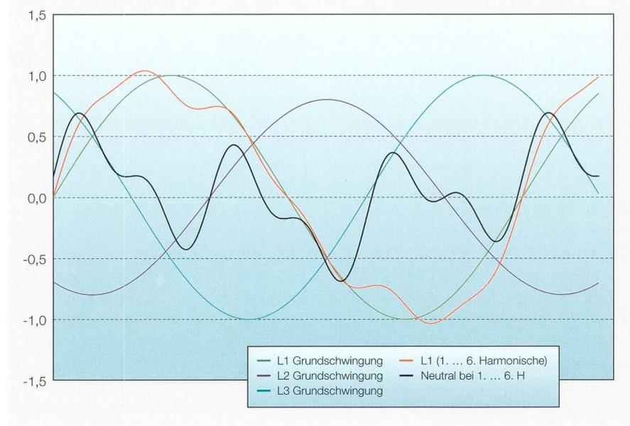
**Bild 1** Neutralleiterspannung (schwarz) bei überschwingungsbehaftetem 3-Phasensystem mit Schiefelast.
