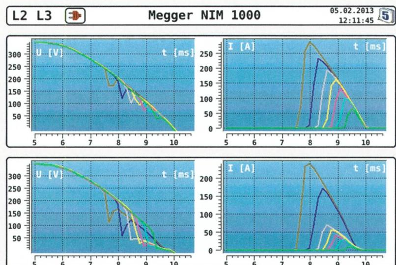
**Bild 5** Fehlerfreie Verbindung (oben) und fehlerbehaftete Phase (unten).
