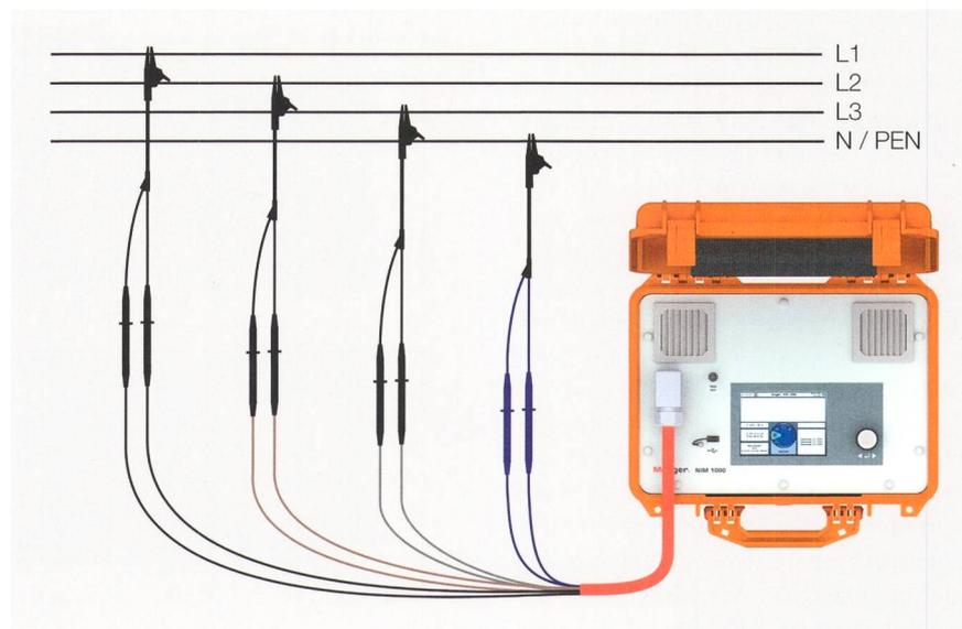
**Bild 3** Anschluss des NIM 1000 an ein Messobjekt.
