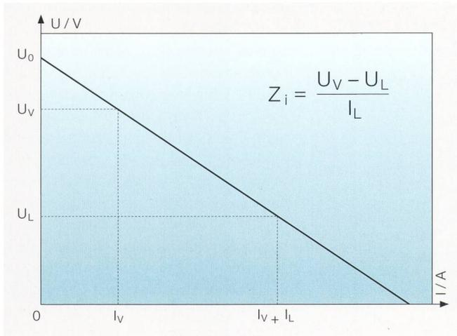
**Bild 2** Kennlinie einer idealen Spannungsquelle mit Innenwiderstand  $Z_i$ .
