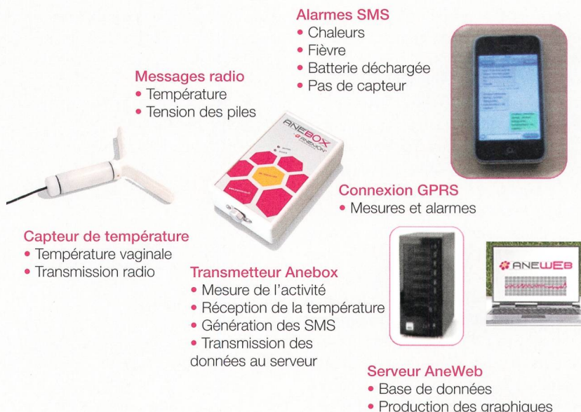
Figure 6 Vue synoptique du système Anemon.
