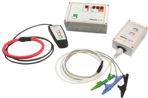
Das Kabelauslesegerät CI/CL von SebaKMT besteht durch seine einfache Bedienung. Es kann bei Niederspannungskabeln ohne Abschaltung der Netzspannung eingesetzt werden. Für die Auslese an freigeschalteten Kabeln dient ein Auslesegenerator der Impulse bis zu 100 A erzeugt. Das Gerät wird in einem Koffer als komplettes Set geliefert.
