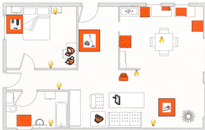
Figure 1 Maquette de l'habitation considérée, d'une consommation de 2610 kWh/an avec une puissance maximale de 4200 W c .
