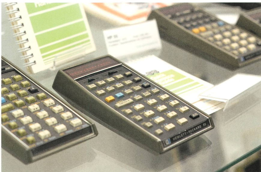
Eine Vitrine ist diversen Hewlett-Packard-Rechnern gewidmet. In der Mitte ist das 1975 eingeführte Modell 55 sichtbar, ein programmierbarer Taschenrechner mit Stoppuhrfunktion.
