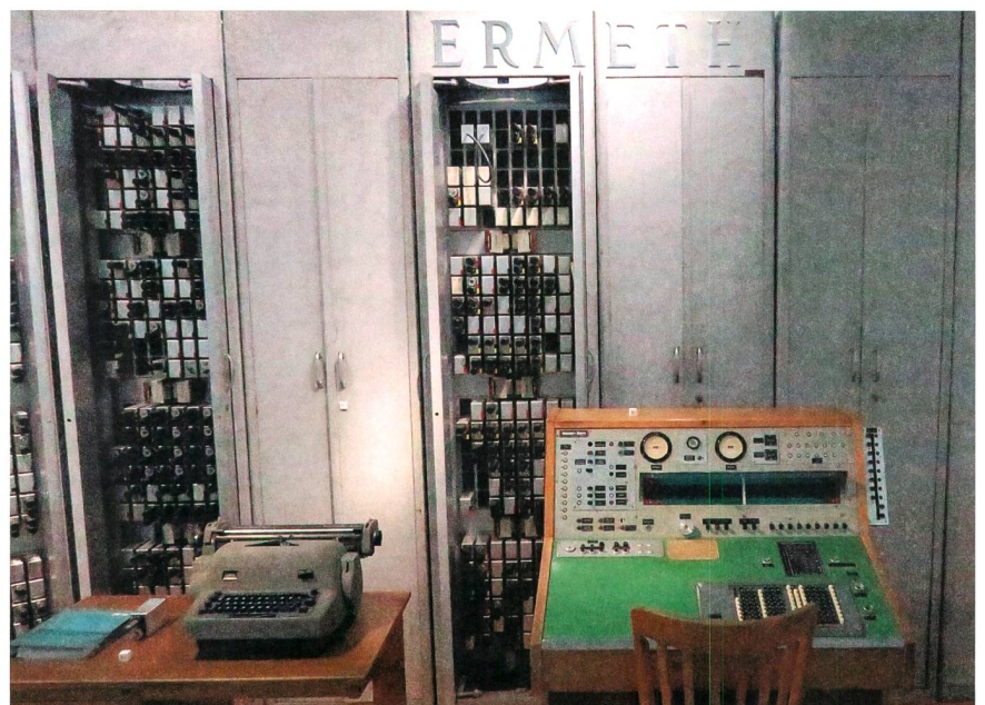
Bild 1 Die elektronische Rechenmaschine der ETH, Ermeth, ist nun im Museum für Kommunikation, Bern, ausgestellt. Die zehn Röhrenschränke sind mit insgesamt 1900 Elektronenröhren ausgerüstet, deren Kühlung eine Herausforderung darstellte. Die Schreibmaschine diente dem «Abtippen» der Resultate und stellte somit das Ausgabegerät dar.
