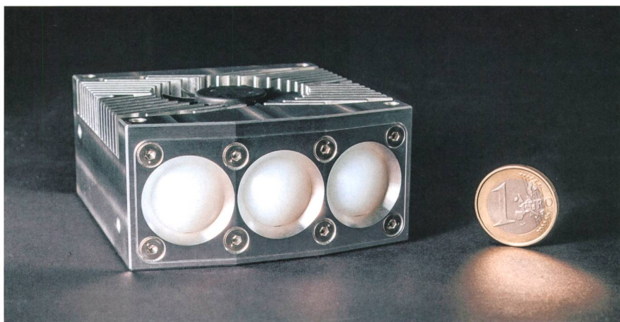
Un système radar à plusieurs antennes pour la détection d'informations spatiales.
