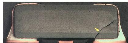
**Bild 2** Bruchstelle in einem Keramik-Kondensator (Schliffbild). Der Bruch ist von oben durch die Lötkepappe verdeckt und durch Inspektionen nicht erkennbar. Häufig entstehen nur winzige Risse, die erst nach längerer Zeit zu Kurzschlüssen führen.
