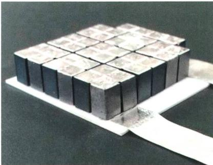
Thermoelektrisches Modul, das bei einer Temperaturdifferenz von 800 °C eine Leistungsdichte von bis zu 640 mW/cm<sup>2</sup> erzielt.
