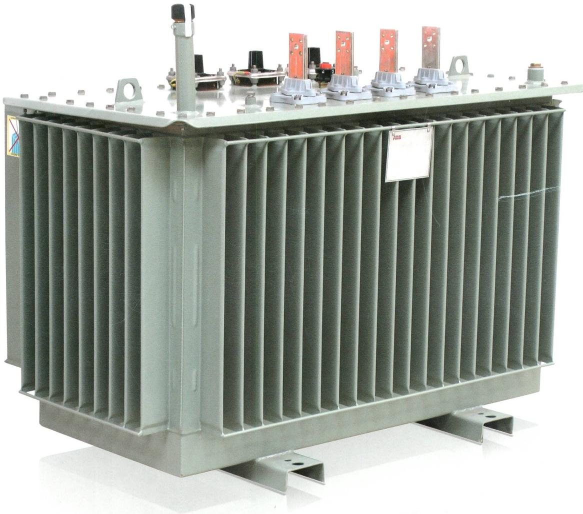
Die ABB-Verteiltransformatoren mit amorphem Kern sind eine extrem verlustarme Lösung. Die einzigartige Legierung des Kerns besteht aus Metallatomen, die in einem unregelmässigen Gitter angeordnet sind. Dadurch sinkt der magnetische Widerstand und verringert die Verlustleistung um bis zu 70 % im Gegensatz zu Kernen mit herkömmlichem Transformatorenblech. [abb.com](http://abb.com)
