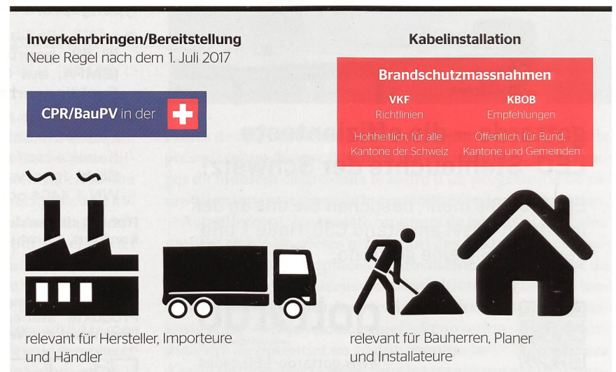
Bild 2 Inverkehrbringen/Bereitstellen im Gegensatz zur Kabelinstallation.
