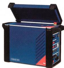
Das Cibano 500 Leistungsschalterprüfsystem.
