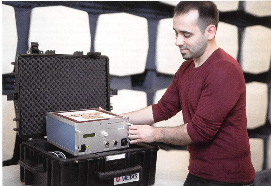
Figure 1 Appareil pour valider les essais d'immunité conduite selon la norme IEC 61000-4-3.
