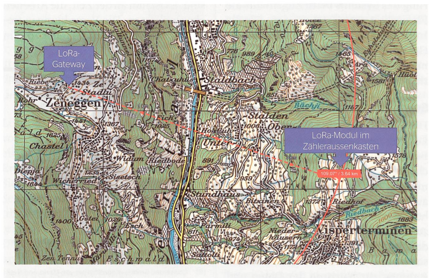
Bild 1 Feldtest 1 - Anordnung Lora-Gateway und Modul mit Sichtkontakt. (Reproduziert mit Bewilligung von Swisstopo [BAT170067])
