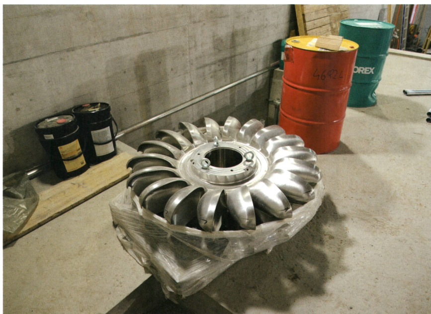
Auch ein Ersatz-Pelton-turbinenrad ist bereits vor Ort.
