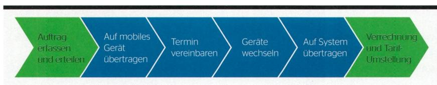
Bild 1 Prozess Datenfluss bei Zählerwechsel.
