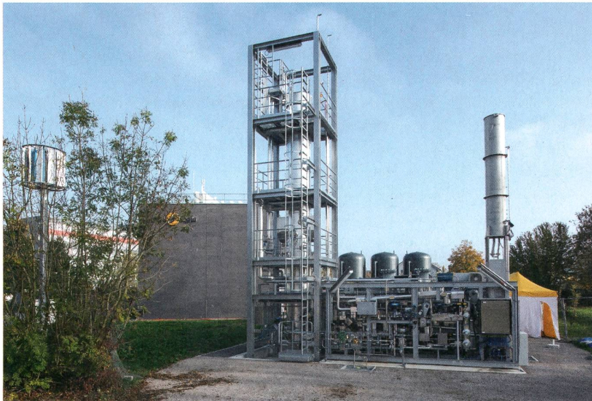
Im Reaktorturm (Bildmitte) findet die biologische Methanisierung bei 62 °C statt.
