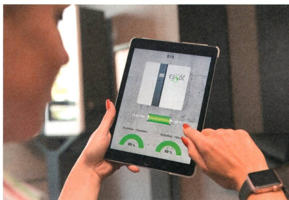
Alle Funktionen und Betriebsdaten des Hauskraftwerks lassen sich über mobile Geräte überwachen.
