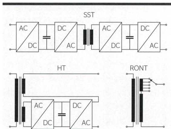
**Bild 1** Vereinfachte schematische Darstellung der untersuchten Transformatortechnologien.
