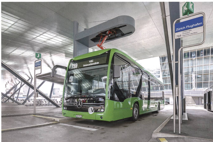
Die Fahrerin oder der Fahrer platziert den E-Bus unter dem Schnelllademast, der Pantograph der Schnellladestation senkt sich ab und lädt die Batterien des Busses auf.
