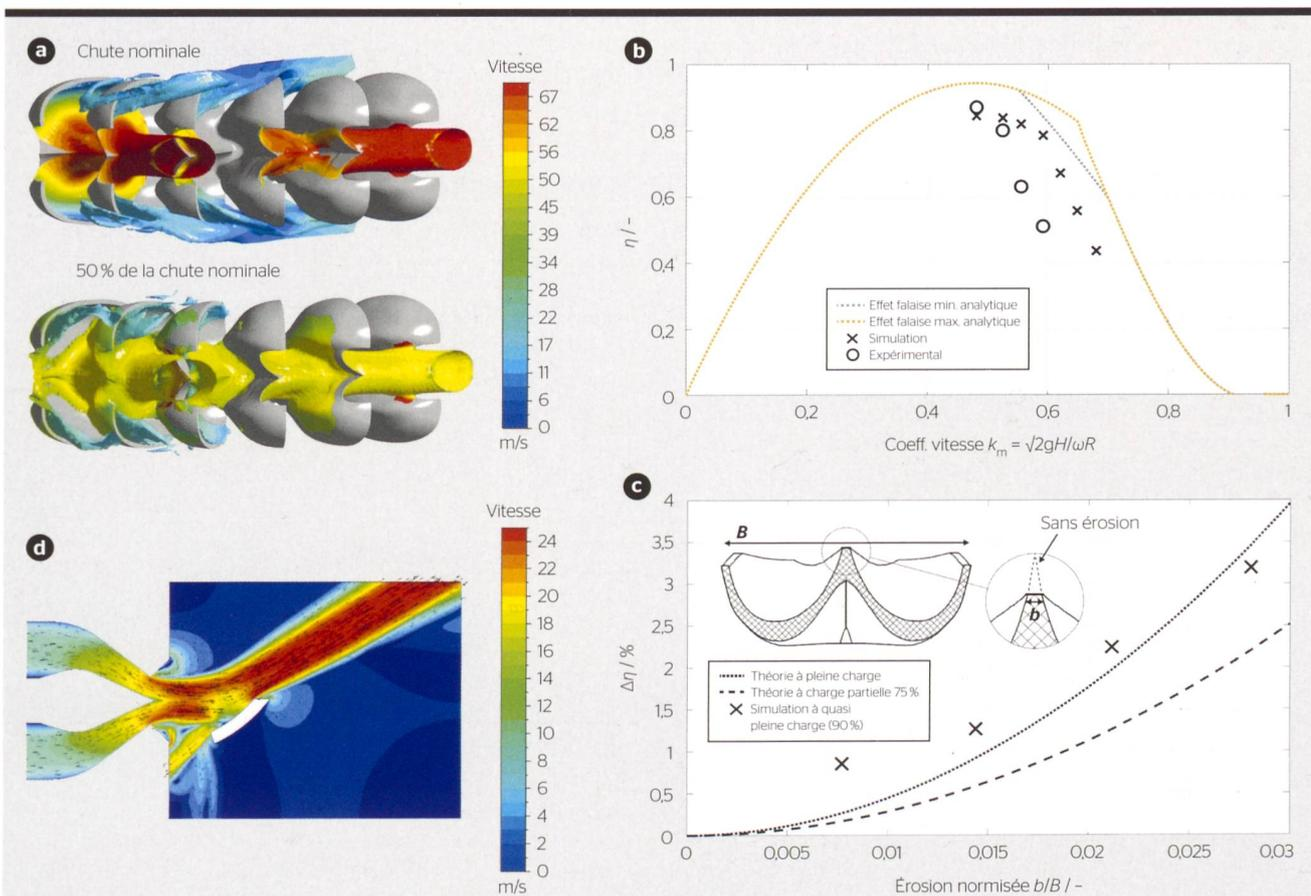
**Figure 4** a) Effet falaise détaillé par l'écoulement des nappes d'eau. Diminution du rendement engendré b) par l'effet falaise et c) par l'érosion, et d) champ de vitesses d'un jet d'eau impactant un déflecteur.
