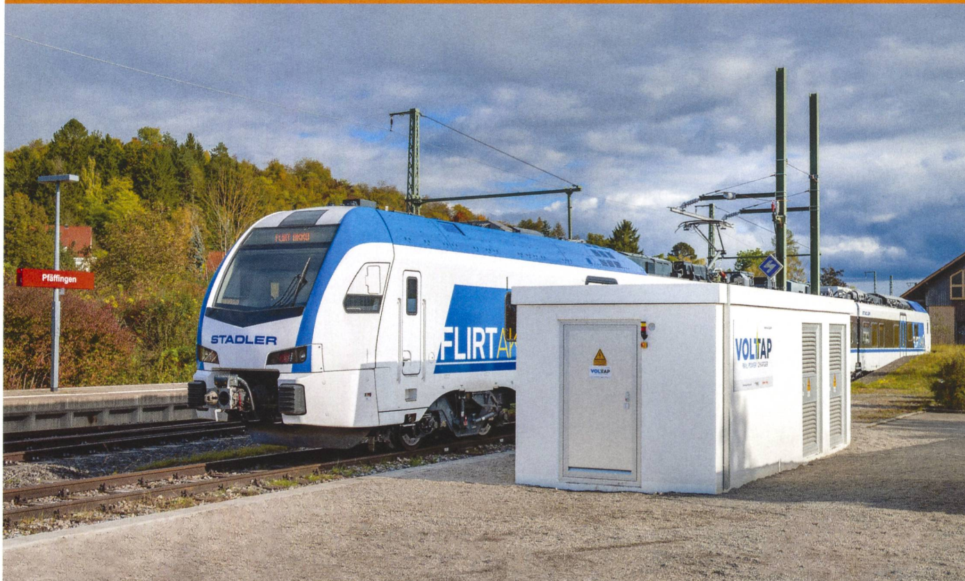
Prototype de station de recharge rapide Voltap pour trains à batterie.
