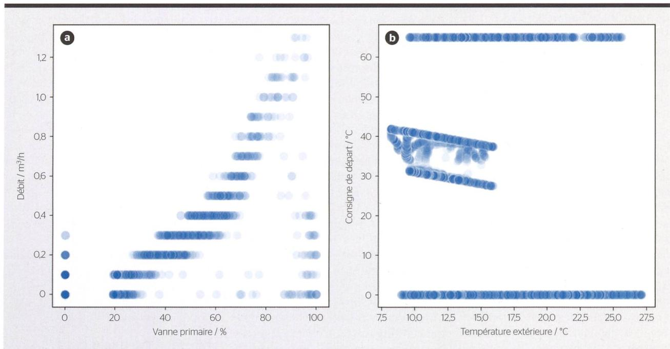
**Figure 2 a)** Distribution bivariée de l'ouverture d'une vanne en relation avec son débit afin d'identifier les blocages. **b)** Visualisation de la consigne de départ en fonction de la température extérieure: ceci permet d'obtenir la courbe de chauffe et de détecter d'éventuels problèmes de régulation.
