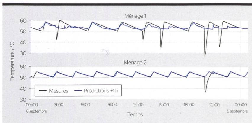
**Figure 3** Comparaison des mesures et prédictions pour deux ménages à l'aide de modèles individuels utilisant des réseaux neuronaux récurrents pour la prédiction de séries temporelles. Il est possible de prédire le fonctionnement de l'installation technique, mais l'utilisation de l'eau chaude relève d'un comportement aléatoire plus difficile à prédire.
