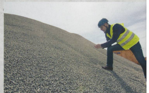
Schonung wichtiger Ressourcen durch das gewonnene Betongranulat
