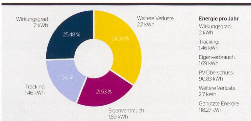
**Bild 4** Verteilung der Verluste der Off-Grid-Webcam gemäss Tool-Berechnungen.
