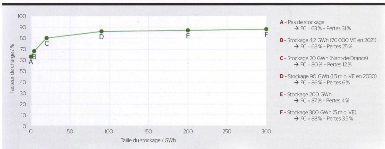
Figure 5 Influence de différentes tailles de stockage sur le facteur de charge (FC) d'une installation équilibrée photovoltaïque-éolienne avec un écrêtage fixé à 16% de la puissance nominale (installations d'une puissance totale d'environ 15 GW, pour une production annuelle de 10 TWh de PV et 10 TWh d'éolien).
