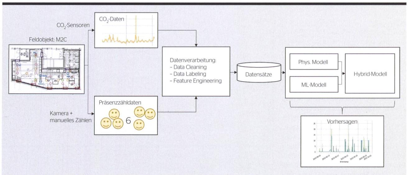
**Bild 3** Blockdiagramm des ML-Präsenzalgorithmus: Die Daten zur Bestimmung der Präsenzzählungen stammen von CO<sub>2</sub>-Sensoren, die aufbereitet und um abgeleitete Faktoren ergänzt werden. Diese angereicherten Daten werden von den Modellen zur Vorhersage genutzt.
