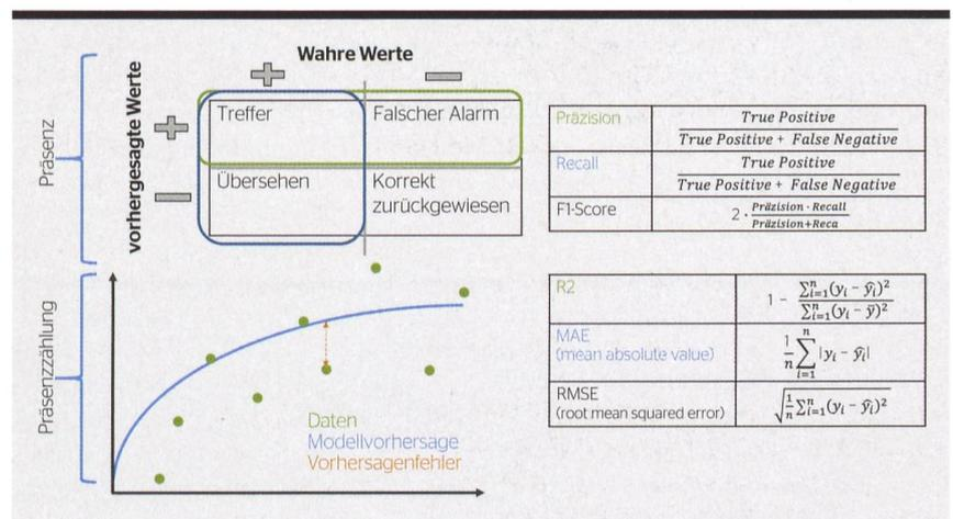
Bild 1 Übersicht der Performanzmetriken für die Erfassung der Genauigkeit der Präsenz: Präzision, Recall und F1-Score resp. Präsenzzählung R<sub>2</sub>, MAE und RMSE.
