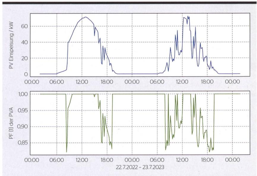
**Bild 2** Einspeiseleistung der PV-Anlage, welche über GridEye angesteuert wird. Blindleistung wurde am Morgen und Abend bezogen, erkennbar am PF der geregelten PV-Anlagen.
