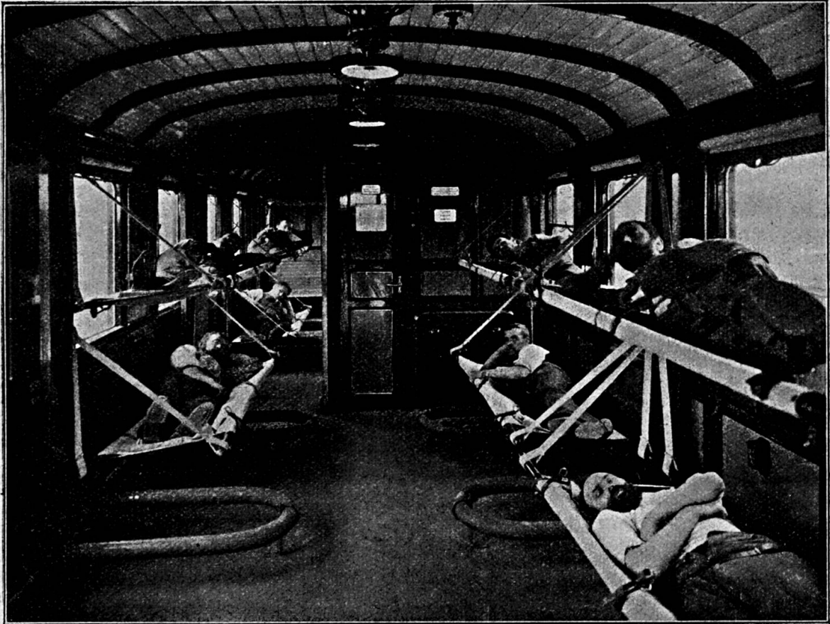
Neuer Personenwagen, eingerichtet zum Verwundetentransport. Innenansicht.
