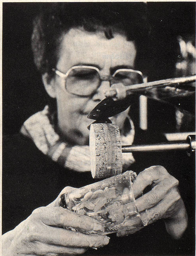
Mit Kork- und Bleirädern wird die fertige Gravur aufgehellt oder poliert
