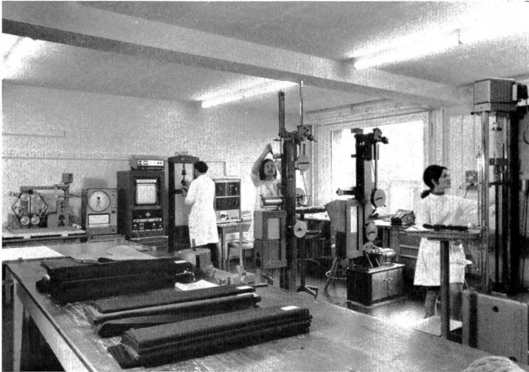
Klimatisierter Prüfraum für physikalische Garn- und Gewebeuntersuchungen.
