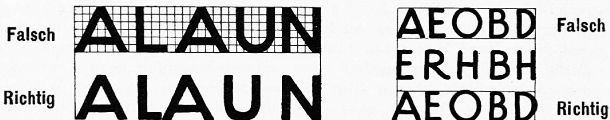
Fig. 28. Richtiges und falsches Abwägen der Zwischenflächen. Richtige und falsche Gestaltung der seitlichen Schriftfeldbegrenzung. Richtige und falsche Höhe der oben und unten rund abschliessenden Buchstaben O C G S Q.
