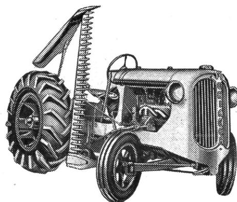
ist technisch vollkommen und praktisch konstruiert; kleinster Rank. Dem rassigen starken Motor steht das richtige Gesamtgewicht des Traktors von ca. 1800 kg gegenüber. Bei grösster Leistung sehr sparsam im Betrieb. Mähapparat mit vollautomatischer Auskupplung, Einzelradabbremse und viele andere Vorteile. Zweckmässige Luftbereifung, Anlasser, Licht etc. Einfach, solid und schön. SA 9120 A
