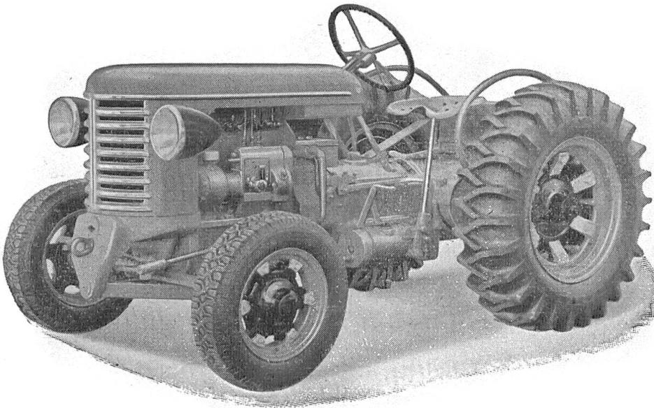
Zentrale Zapfwelle - 7- oder 8-Gang-Getriebe und verschiedene weitere Neuerungen sind die Hauptmerkmale des Bührer-Diesel 1945
