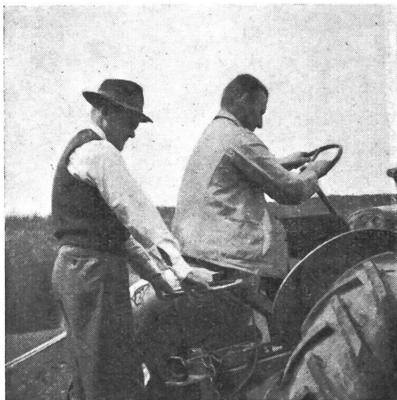
Bequeme und robuste Haltevorrichtung für Mitfahrer am Traktor «Case» VS (Allamand Ballens).
