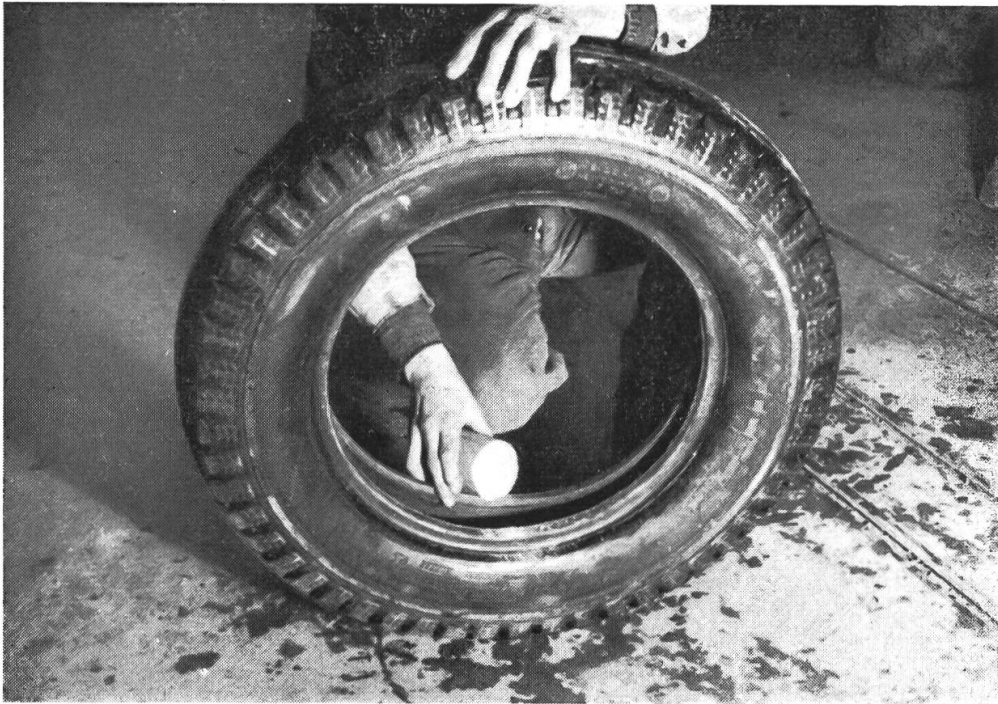
Abb. 9. Einstreuen von Talkpulver zur besseren Konservierung und zur Verhinderung zu starker Reibung. Nachher Montage des Pneus auf der einen Felgenseite, im umgekehrten Sinne, wie Abb. 6.
