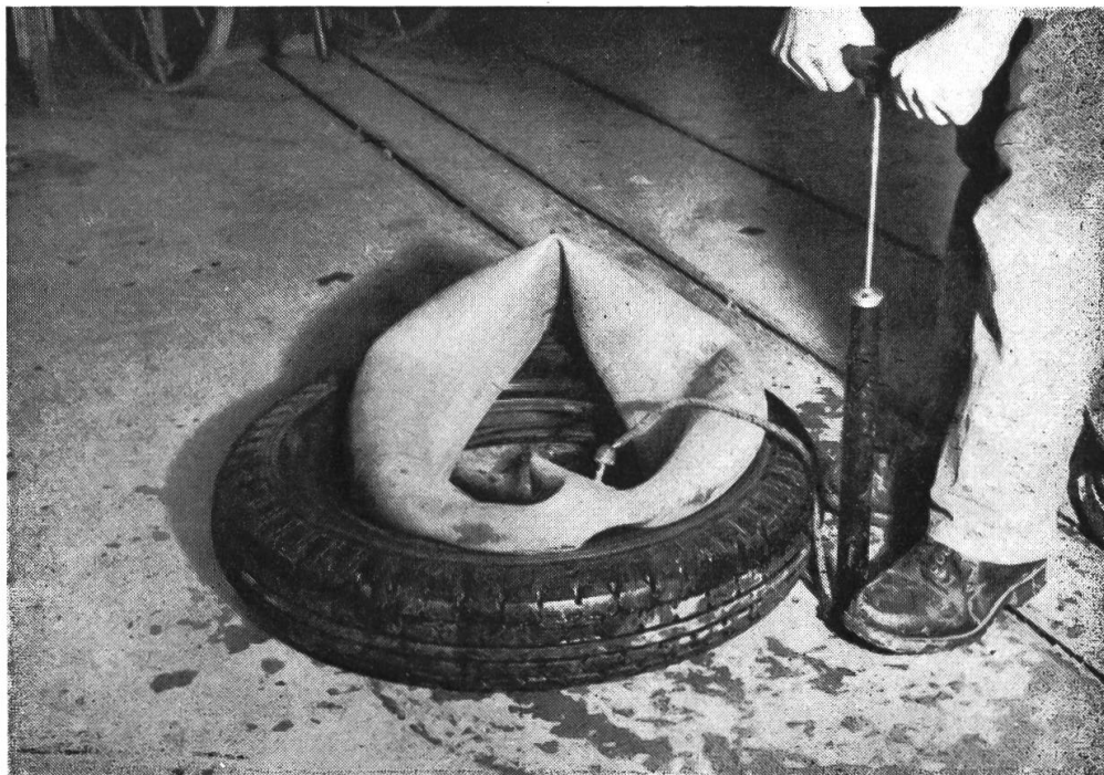
Abb. 10. Leichtes Aufpumpen des Schlauches.
