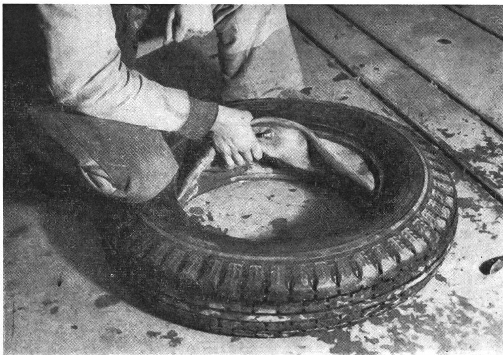
Abb. 5. Sorgfältiges Herausnehmen des Schlauches von der Ventilseite her
