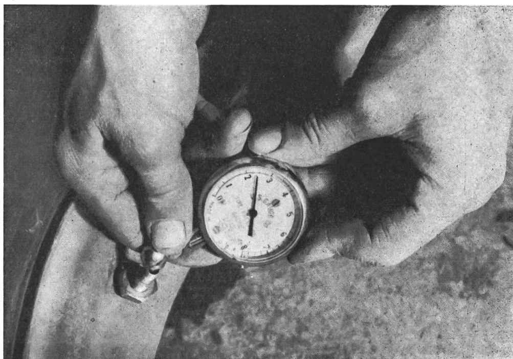
Abb. 1 Kontrolle des Pneudruckes nach der Montage.
