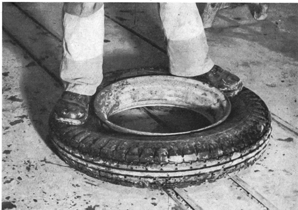
Abb. 3. Lösen des Pneus durch beidseitiges Niederdrücken der Seitenwände (möglichst nahe an den Felgen).
