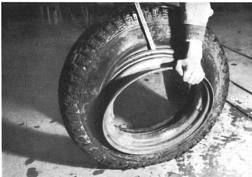
Abb. 6. Entfernen des Pneus von der Felge.
