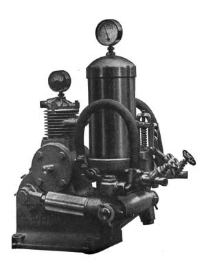
zum Anbau an Traktoren, Mäher und Seilwinden. Für die Baum- und Reben-Spritzung.
