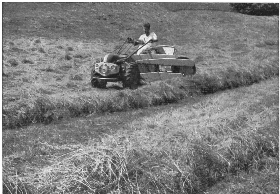
Zapfwellen-Schwadenrechen an einem Einachs-Traktor. Beim Verrichten dieser Arbeit bezahlt der Bauer **Fr. 26.50** je 100 kg Benzin in die Staatskasse, resp. an den Unterhalt der Strasse !
