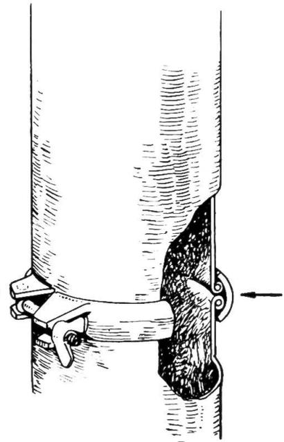
Verbeulte Rohre ausrichten!
