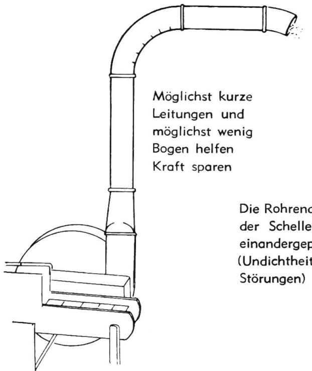
Die Rohrenden müssen mit der Schelle dicht aufeinandergepresst werden (Undichtheiten verursachen Störungen)
