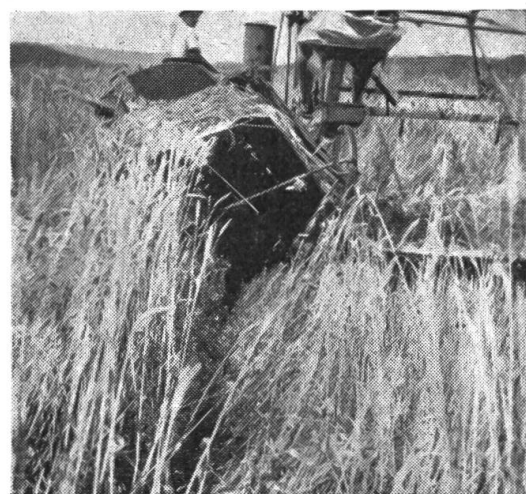
Abb. 2. Das Arbeitsergebnis des Halmabteilers von hinten gesehen.
