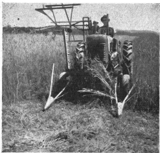
Abb. 1. Halmabteiler an der Vorderachse eines Traktors befestigt.
