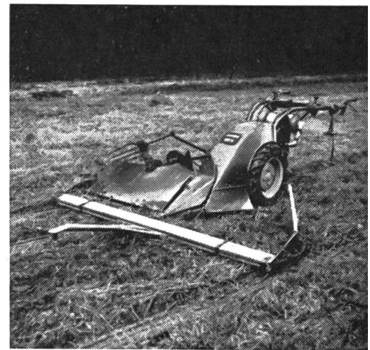
Abb. 3: Motormäher mit am Mähbalken eingehängter Deichsel.
