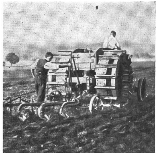
34 a und 34 b Um ein Einsinken zu verhindern, wurden Radverbreiterungen angebracht.
