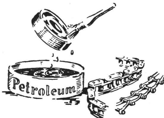
Abb. 7: Entfernen von Oel, Staub usw.
