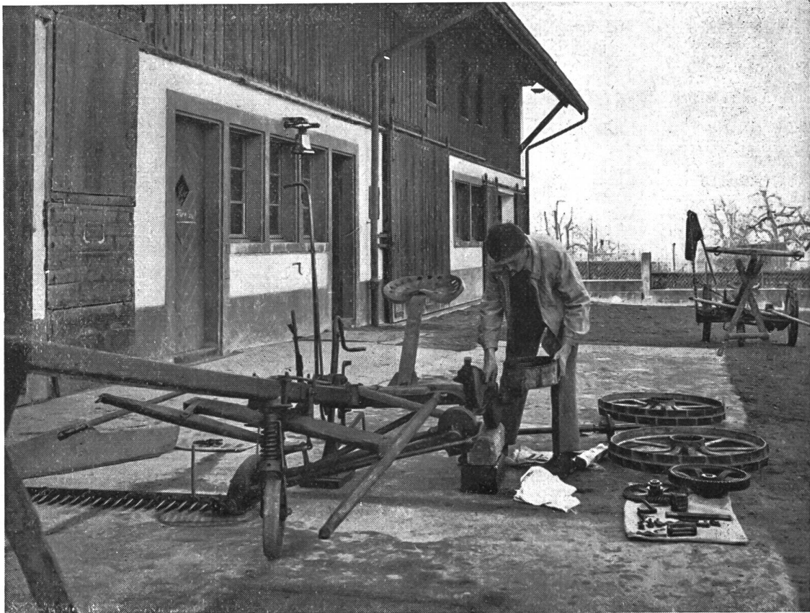
Abb. 11a: Gründliche Revision und Reinigung einer Mähmaschine
